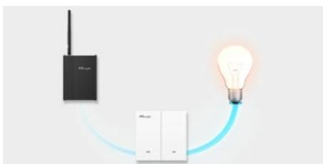
Das exklusive Milesight LoRa-basierte Protokoll ermöglicht eine einfache Kommunikation zwischen Milesight LoRaWAN-Geräten ohne Beteiligung von Netzwerkinfrastrukturen innerhalb von einer Sekunde. Das Einschalten von Geräten wie Lichtquellen kann intelligent durch diese Verbindung gesteuert werden.
